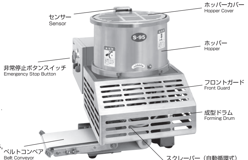
Model S-95V スピードコントロールユニット付 With Variable Speed Controller
